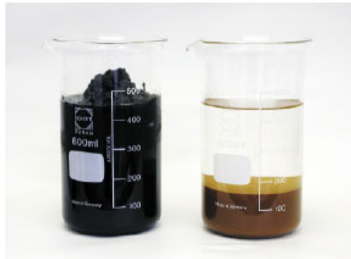
Figur 8 Efter behandling med SCWO återstår av avloppsslammet endast den oorganiska resten uppsamlad i vatten. Bilden visar avloppsslam före behandling samt den oorganiska rest i vatten som återstår efter behandling.
